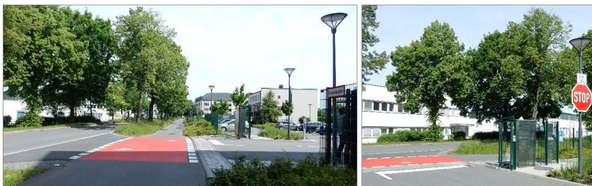
**Bild 33: Zweirichtungsradweg über optisch und baulich gesicherte Einfahrt (Bsp.)**
